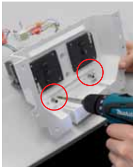
Step 2: Untuk mengganti penyangga saluran air, buka sekrup disebelah nozzle.
