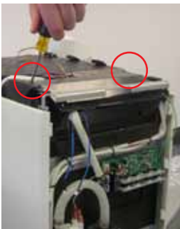
Step 2: Buka cover PCB dengan melepas 2 sekrup.
