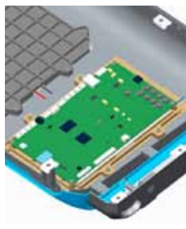
Step 1: Cek atau ganti MMI PCB layar sentuh atau display.
