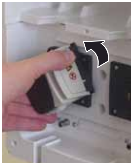
Step 2: Putar berlawanan arah jarum jam untuk membuka pompa.
