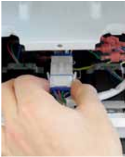
Step 4: Lepaskan se lang dari konektor dan lepaskan juga kabel.
