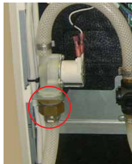
Step 2: Buka konektor selang dan lepas solenoid inlet valve.
