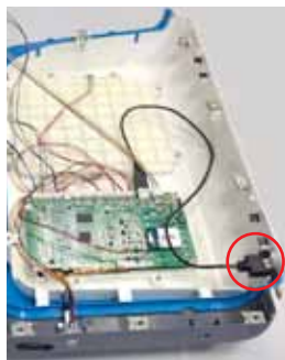
Step 3: Cek atau ganti USB port dan tutupnya.
