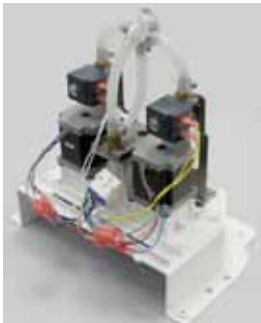
Step 1: Lepaskan plat penyangga pompa.
