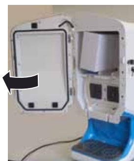
Step 1: Lepas pintu dari mesin. (lihat poin 14.1.5)
