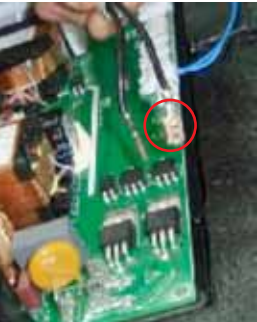
Step 1: Lepas terminal kipas dari main board.
