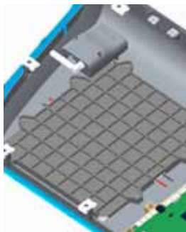
Step 2: Cek atau ganti lampu be- lakang, LED, atau modul GPRS.
