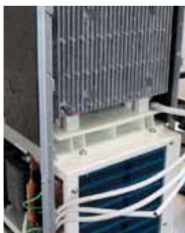
Step 6: Buka kabel (termasuk kabel NTC).
