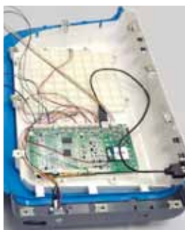
Step 6 : Lepas konektor dari MCB dan dan PCB dari MMI PCB (CPU).
