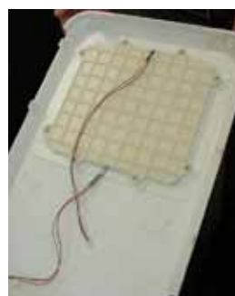
Step 4: Buka konektor LED, dan lepaskan panel belakang.
