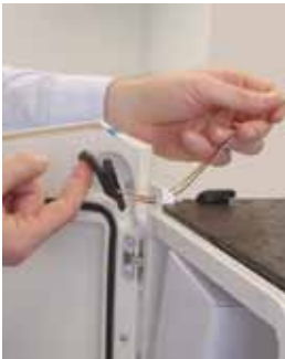
Step 3: Buka penyangga kabel dari dudukannya.
