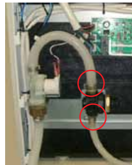
Step 1: Untuk mengganti valve, buka X klip dari selang. lalu lepas sambungan tsb.
