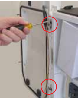
Step 4: buka 4 sekrup di engsel pintu sesuai gambar.
