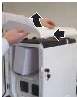
Step 3: Geser panel atas ke depan lalu angkat ke atas.
